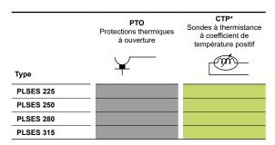
Quantité maximum à la commande ≤ 2 pièces. Elle ne peut dépasser la quantité maximum du produit de base. Le délai demandé ne peut être inférieur à celui du produit de base. \* CTP 150°C
